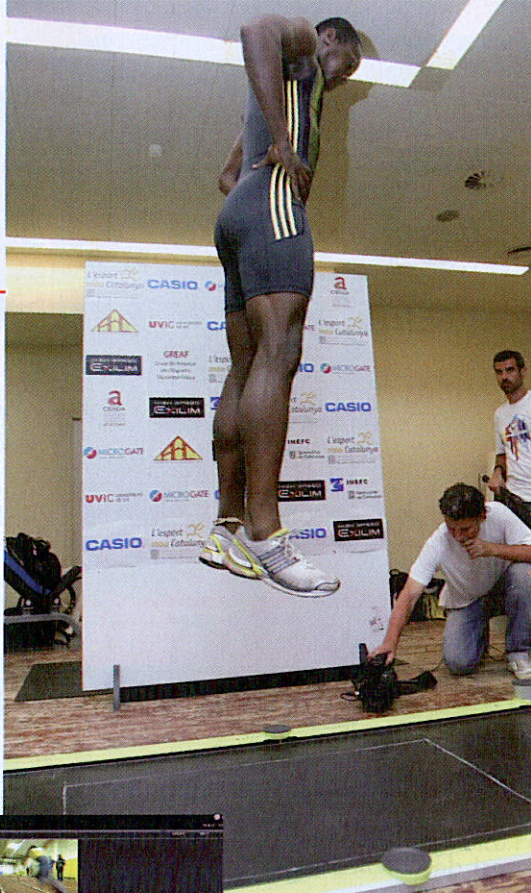
Dyron Robles (oro a Pechino nei 110 ostacoli) durante un test di balzi effettuato con OptoJump a Barcellona. A lato, visualizzazione in tempo reale dei dati acquisiti durante l'esecuzione di un test, con analisi del video, grafici a linee e barre e dati numerici relativi alle diverse misure (tempi, altezze, lunghezze, potenza...)
