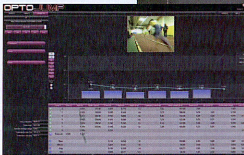
Dyron Robles (oro a Pechino nei 110 ostacoli) durante un test di balzi effettuato con OptoJump a Barcellona. A lato, visualizzazione in tempo reale dei dati acquisiti durante l'esecuzione di un test, con analisi del video, grafici a linee e barre e dati numerici relativi alle diverse misure (tempi, altezze, lunghezze, potenza...)
